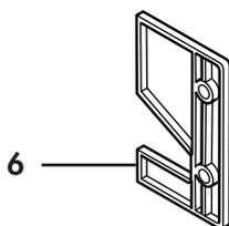
**6 CALE** en matière plastique blanc ou brun, épaisseur 4 mm permet d'augmenter la profondeur de la feuillure S si celle-ci est < à 19 mm
