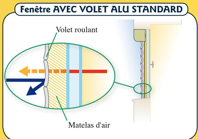
Avec un volet baissé, l'espace vide entre la fenêtre et le volet constitue un matelas d'air qui retient la chaleur qui s'échappe. Mais cette chaleur finit néanmoins par sortir. Les volets roulants aluminium standard ne permettent pas d'obtenir une résistance thermique additionnelle pour l'ensemble volet-lame d'air ventilé supérieure à 0.20 m<sup>2</sup>°K/W.
