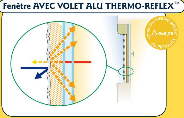
La chaleur qui s'échappe est renvoyée vers l'intérieur. La température du matelas d'air est plus élevée. La faible émissivité des lames retient la chaleur et évite un échange thermique immédiat avec l'extérieur. Seules les lames aluminium THERMO-REFLEX™ permettent d'obtenir une résistance thermique additionnelle pour l'ensemble volet-lame d'air ventilé supérieure à 0.20 m<sup>2</sup>°K/W.
