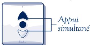
**NB :** *Si le tablier se déplace alors de millimètre en millimètre, c'est que la mémorisation de la position intermédiaire n'a pas été enregistrée. Recommencer l'opération.*
