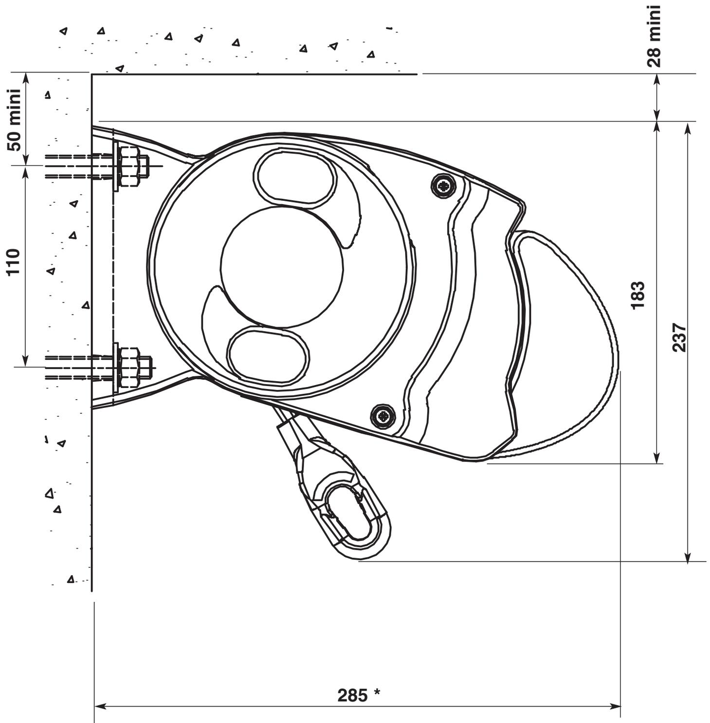
\* Avec plaque de fixation : la cote de 285 mm devient 300 mm
