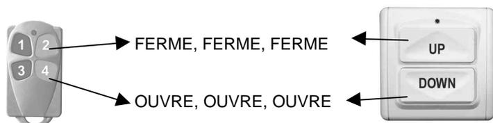
Pour donner une commande de STOP au store / volet roulant, appuyer sur la touche attribuée à la fonction de fermeture, si le store / volet roulant est en phase d'ouverture, et la touche attribuée à la fonction d'ouverture est en phase de fermeture.
