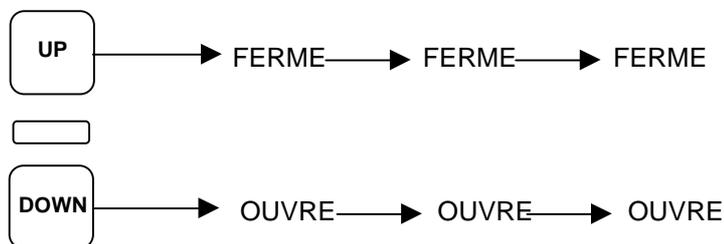
Pour activer une commande de STOP, si, le store / volet roulant est en phase d'ouverture, appuyer la touche affectée à la fonction de fermeture. si, le store / volet roulant est en phase fermeture, appuyer la touche affectée à la fonction d'ouverture.
