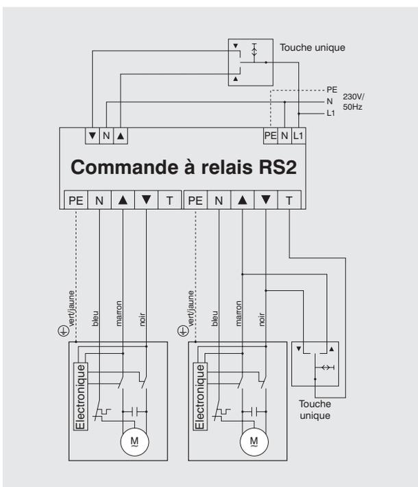
Activation de plusieurs moteurs avec commutation de fin de course mécanique et électronique
