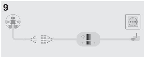
5. Sécurisez le moteur avec la goupille fendue, selon le type de fixation du palier de store. La mise en service peut avoir lieu soit avec le câble de réglage **BECKER** (réf. 4901 002 181 0, pas de reset moteur possible), soit avec le câble de réglage **BECKER** pour les moteurs avec réglage des fins de course électroniques (réf. 4935 200 011 0).
