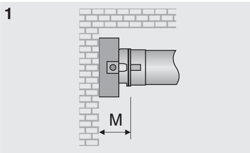
Le monteur doit s'assurer au préalable que le mur resp. le coffre de volet roulant présentent la solidité requise (couple du moteur plus poids du volet roulant).
