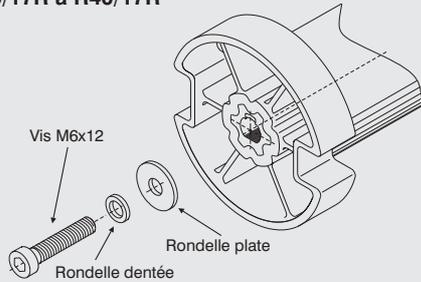
• **Montage des moteurs R8/17R à R20/17R avec sûreté pour la roue d'entraînement**
