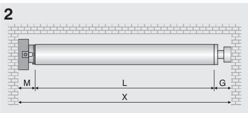
1. Calculez l'encombrement latéral (M) de la pièce de tête, de la contre-portée et du palier du moteur (fig. 1), afin de calculer la longueur nécessaire de l'arbre. La dimension intérieure du coffre du volet roulant (X) moins la longueur totale du palier du moteur, de la contre-portée (G) et de la pièce de tête (M), donnent la longueur de l'arbre (L):
