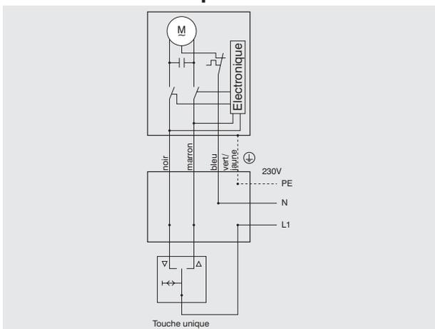
Activation d'un moteur avec une horloge U25 ou d'un poussoir Memory MT11
