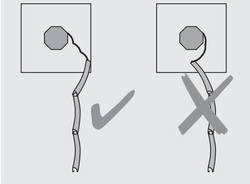
Si vous avez monté une sécurité anti-effraction, vérifiez son bon fonctionnement conformément aux indications du fabricant. Elle doit être bien enclenchée et presser contre le rebord de la fenêtre. Elle doit presser la lamelle supérieure en position debout contre le coffret de volet roulant (fig. 12).
