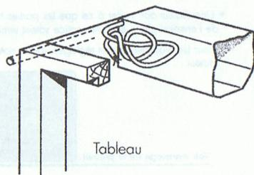
4 - Dans le cas 2, (enroulement extérieur) adapter si besoin les coulisses à la menuiserie.
