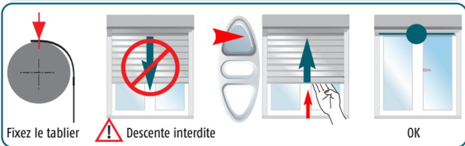
Le réglage de la position basse se fait automatiquement après le réglage de la position haute.
