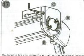
Soulager le bras du store d'une main ou de l'épaule et tourner la vis C avec la clé 6 pans N°6. Régler à l'inclinaison souhaitée. Resserrer les boulons A et B à l'aide de la clé six pans N°6 et bloquer.
