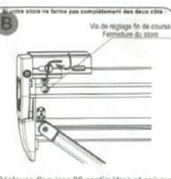
Déployer d'environ 30 centimètres et agir sur la vis haute d'un 1/2 tour vers le ⊕à l'aide de la clé six pans Nº4.
