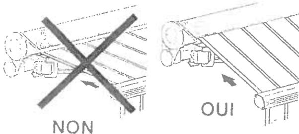
Toujours enrouler la toile par le dessous et non par le dessus du tube. Votre store fermé, mal ou la barre de charge n'est pas à l'horizontal régler l'inclinaison suivant chapitres 6 à 8.
